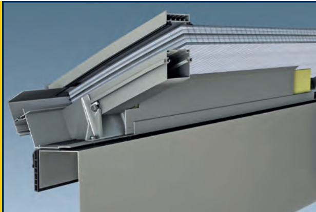
Querschnitt Grundprofil ESSMANN® Lichtband ih mit 2 x 16 mm AeroTech-Verglasung und Wärmedämmung für Grundprofil
